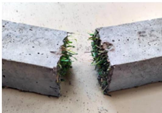
nostro Ateneo stanno studiando, con successo, l'impiego di fibre di materiale plastico di riciclo da tappeti di erba artificiale, derivanti da campi sportivi dismessi, come agente di rinforzo in calcestruzzi. Allo stato attuale, tale materiale di scarto non trova alcuna applicazione ed è destinato alla termovalorizzazione. Nei calcestruzzi (figura sopra), i materiali fibrosi sono in grado di apportare notevoli capacità dissipative, grazie
