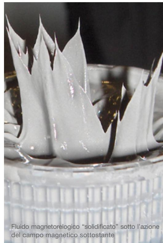
Fluido magnetoreologico "solidificato" sotto l'azione del campo magnetico sottostante
