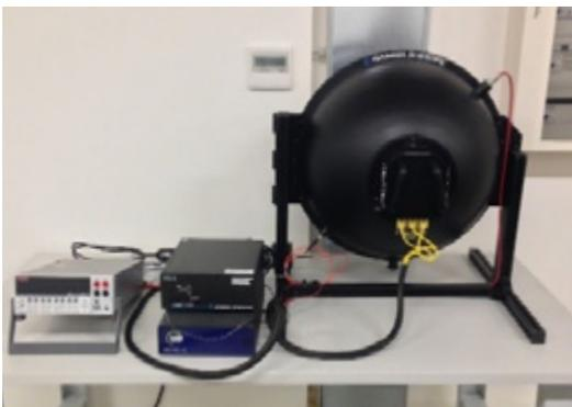
Sfera integratrice per la caratterizzazione di sorgenti LED all'interno del laboratorio Bright-Lab del Centro Interdipartimentale En&tech situato all'interno del Tecnopolo di Reggio Emilia (Capannone 19 delle ex Officine Reggiane).
