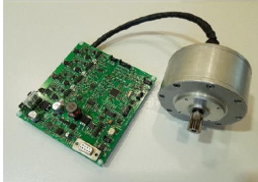
Prototipo di inverter e motore elettrico a magneti permanenti custom sviluppato per un consorzio di aziende regionali per applicazioni oleodinamiche e macchinari agricoli. Prototipi sviluppati presso il laboratorio Azionamenti Elettrici del Centro Interdipartimentale Intermech MO.RE. (Pad. Tamburini, Reggio Emilia).
